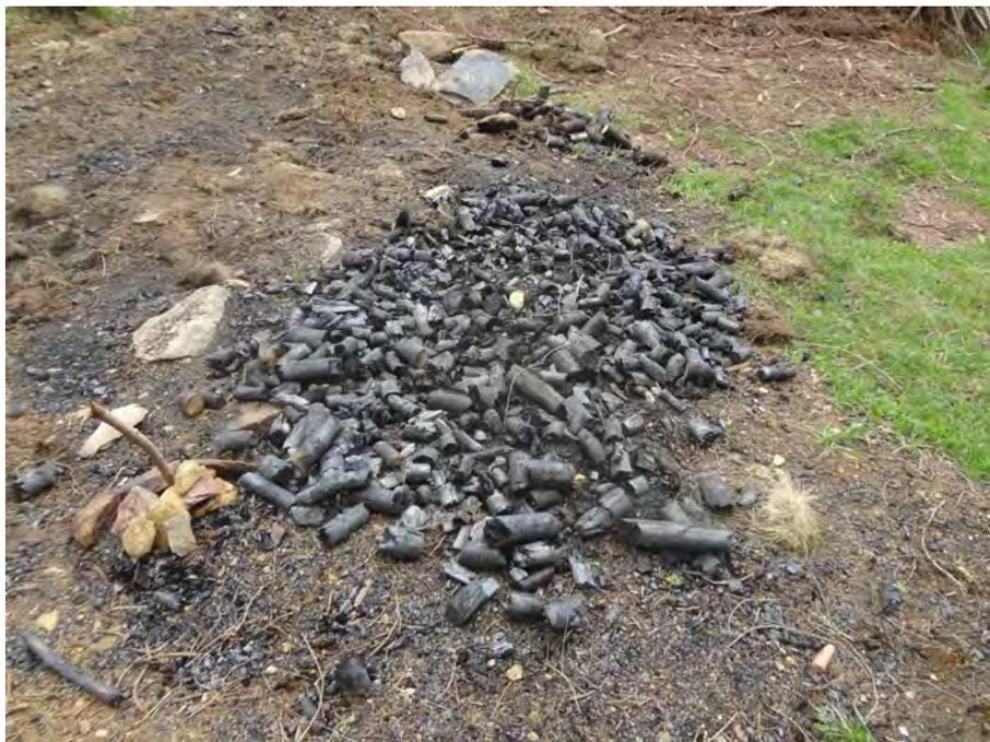
*Fig. 5: Carbone come prodotto di pirolisi da materiale di rami*
